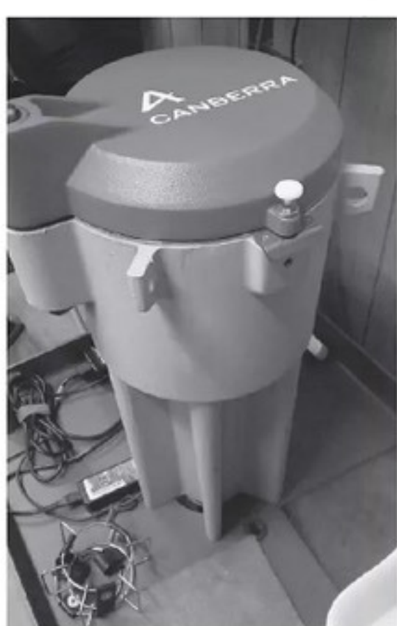
今回のセシウム測定に使った機械。この中に乾燥させた泥を入れる。正確な値が出るよう、専門家の指導を受けながら測定に臨んだ
