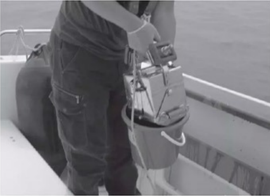
取材班はボートを操船しながら、各ポイントで川底の泥を採るための採泥器を投げ入れる。波の状態や水深によっては一日で5、6ヵ所しか採れないことも
