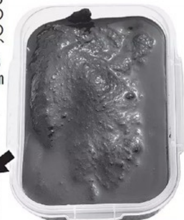
採取した泥の水分を1、2週間かけて完全に飛ばしてから測定を行なう。水分が入っているとセシウム濃度が薄められ、正確な数字が出ないためだ
